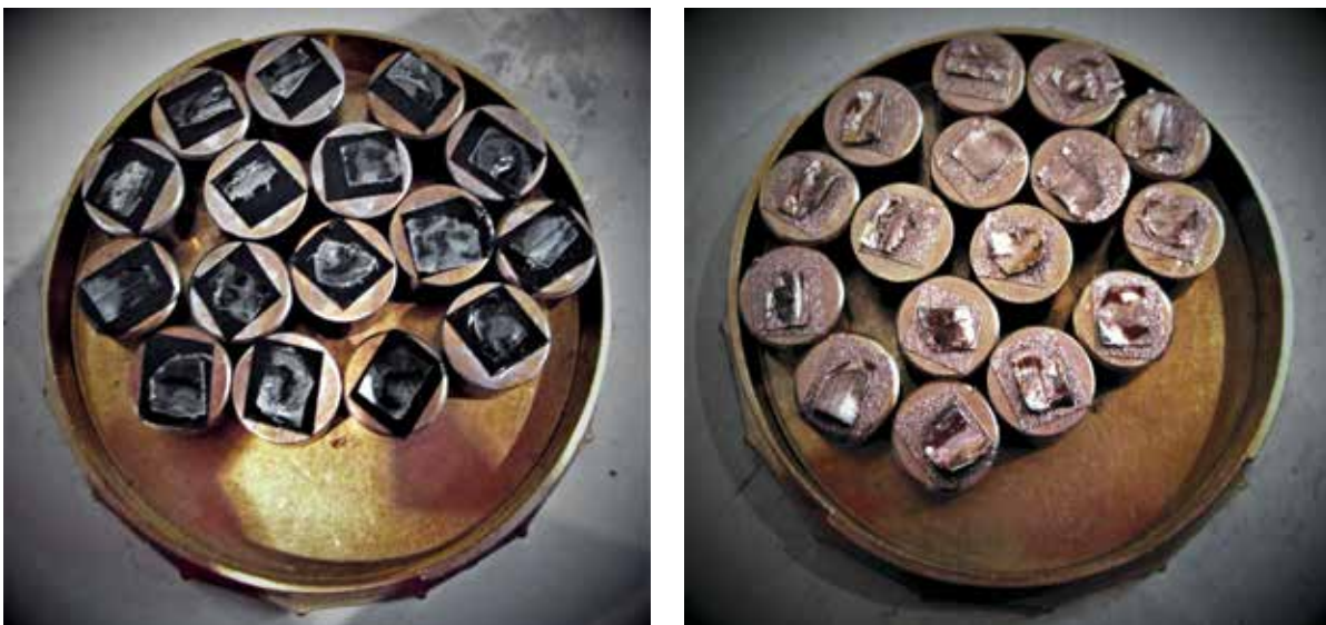
FIGURA 80. Polímeros antes y después del recubrimiento con iones de oro (vc).
